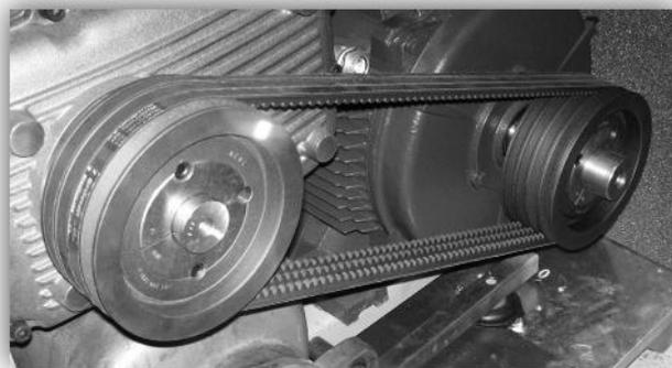
Figura 10. Trasmissione a pulegge e cinghie.
