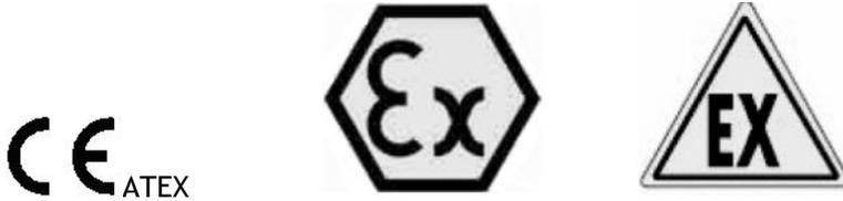
Figura 2. Certificazione ATEX e indicazioni su atmosfere potenzialmente esplosive.
