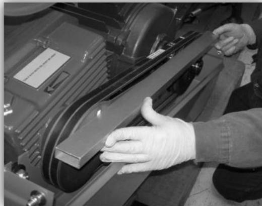
Figura 34. Allineamento delle pulegge.
