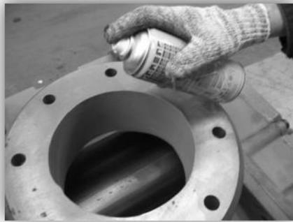
Figura 45. Pulizia interna del nucleo del compressore.
