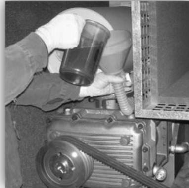
Figura 51. Sostituzione dell'olio.
